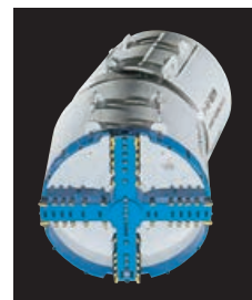
型式 φ3080mm泥土圧式シールド掘進機 R10m対応型(左右16.4°・上下0.5°)
