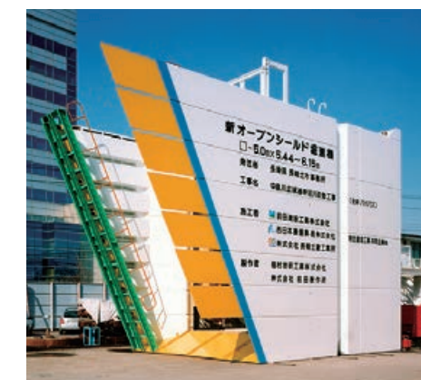
長崎オープン 型式 □5000mm×5440mm 新オープンシールド掘進機
