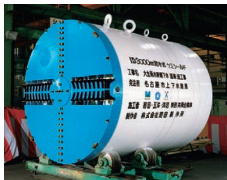
型式 φ3000mm泥水加圧式セミシールド掘進機
